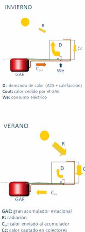
Fig. 1. Sistema de Climatización y Agua Caliente Sanitaria (SCACS) con energía solar. Fuente: Moisés Morató y BCNecología.
